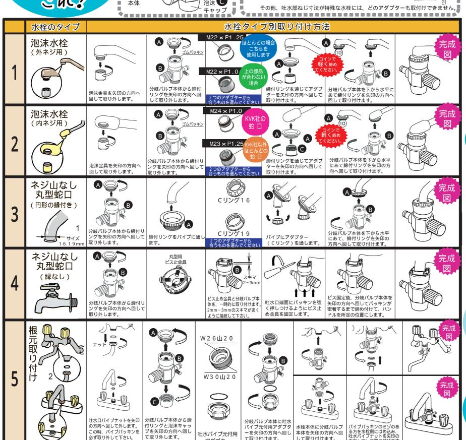
1 ネジ山なし丸型蛇口(円形の縁付き)のパイプ径が17.5mmの場合は、丸型用ビス止金具で対応します。
